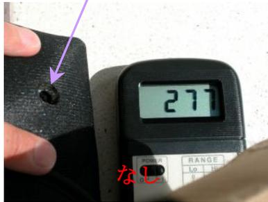
紫外線強度センサー（扶桑理化学製品様の UV-340 を使用）
